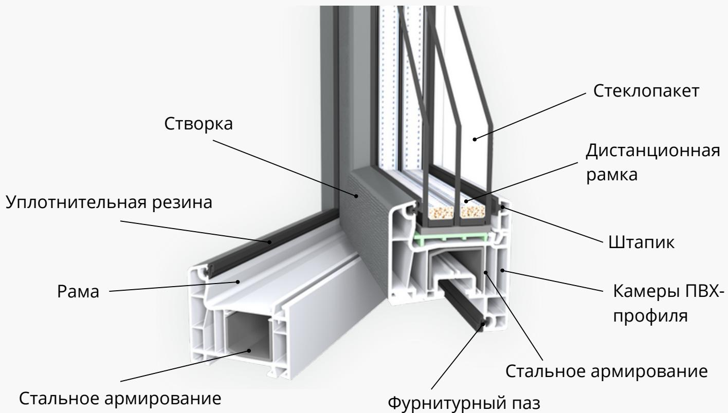
1. Стеклопакет - это состоящая из двух или более стекол конструкция, которая разделена дистанционной рамкой и герметично скреплена двумя контурами герметика.
